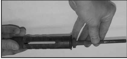
DESATORNILLE EL BUJE DE LA BOCA DEL CAÑON
