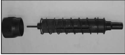
DESLEE EL CONJUNTO DEL CAÑÓN Y EL RESORTE DEL CAÑÓN FUERA DEL CUERPO DE LA HERRAMIENTA
